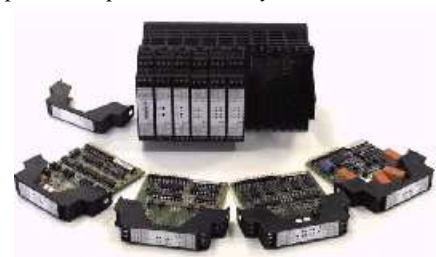
Obr. 2: Základní modul RM213 s deseti pozicemi pro I/O moduly
